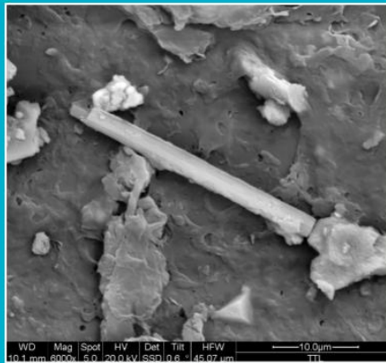
Elektronimikroskooppikuva asbestikuidusta pölynäytteessä. Suurennos on 6000-kertainen.
