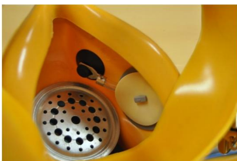
Näytteenottoletkun asennus sisänaamariin
