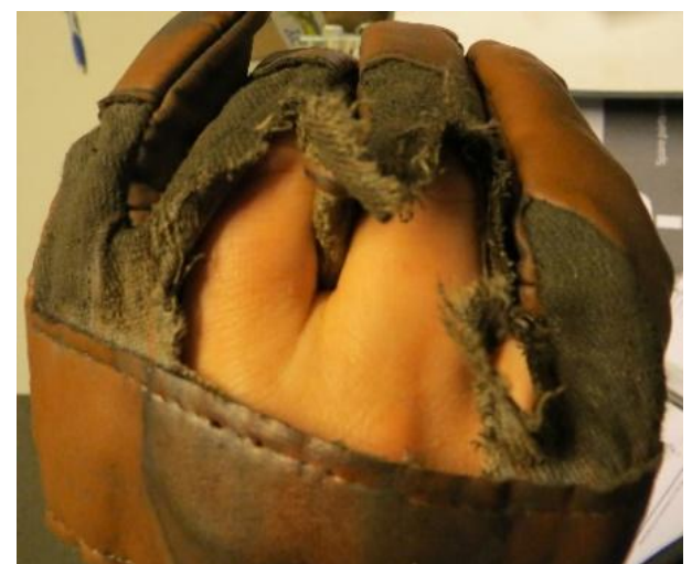
Vääränmallinen suojakäsine palanut puhki
