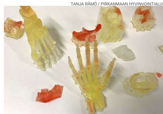
Taysissa tulostetut kolmiulotteiset kappaleet ovat resini- ja muovista, joka kovetaan tulostuksen jälkeen.
